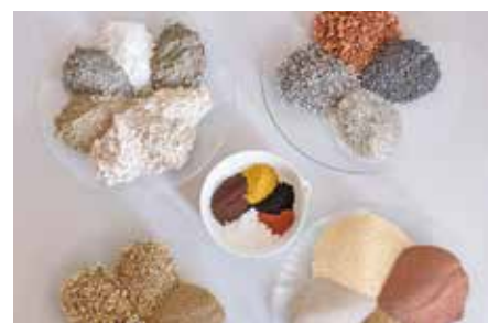
Sélection de liants (en haut à gauche), de sables étrangers et de sables propres (sens des aiguilles d'une montre) ainsi que de pigments (au centre)
