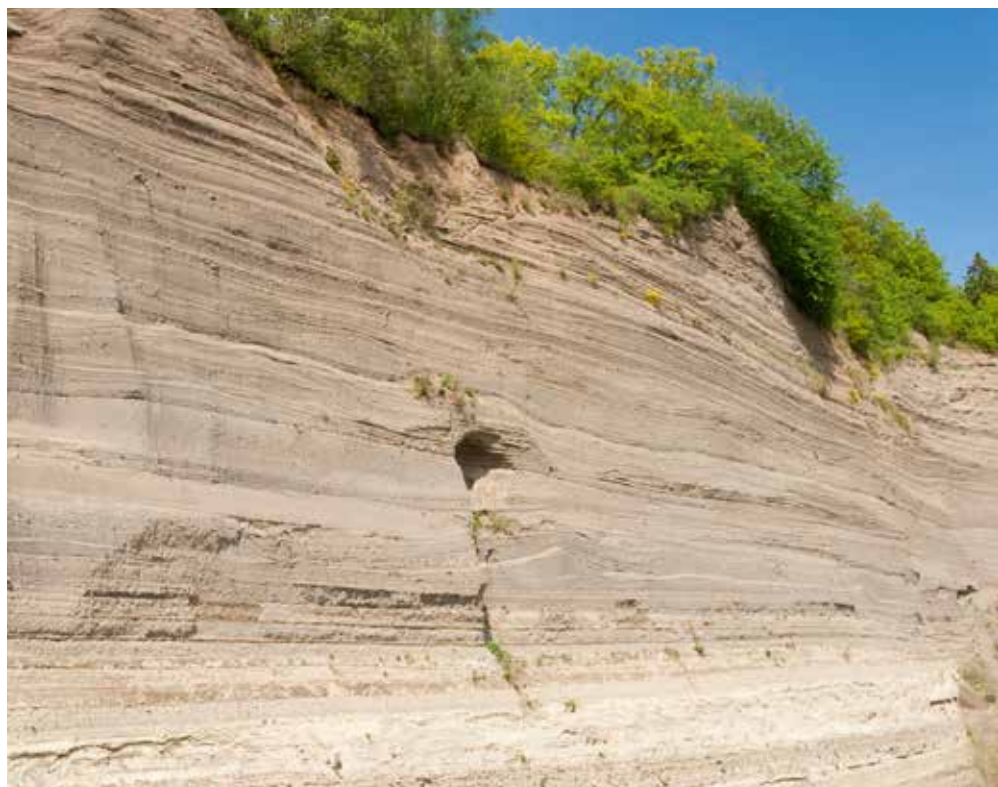
Ancienne exploitation de trass : le trass est utilisé comme additif dans les chaux formulées par tubag
